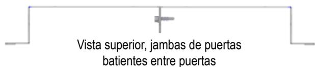
**NOTA:** Si los pisos tienen pendiente, mantenga las jambas y los dinteles a plomo y nivelados. Para eso, perfore orificios nuevos para los dinteles de un solo lado en caso de ser necesario.
